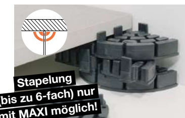
Wenn Sie an der Außenkante Ihrer Fläche halbe MAXI-Lager stapeln, drehen Sie die einzelnen Lager um eine halbe Drehung, also um 180 Grad versetzt.
