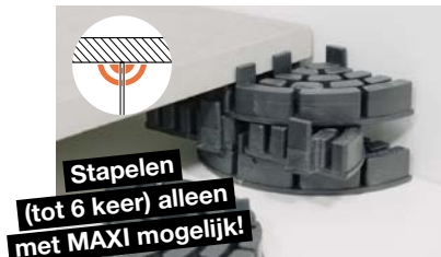
Als u halve MAXI-dragers aan de rand van de tegelvloer stapelt, draait u de afzonderlijke dragers een halve slag, d.w.z. 180 graden ten opzichte van elkaar.
