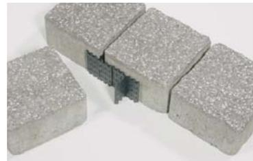
Pour la pose à joints décalés, vous pouvez commander des pièces en T en départ d'usine ou couper un croisillon à l'endroit prévu pour et utiliser la pièce T ainsi obtenue. Selon la hauteur des dalles à poser, vous pouvez empiler les croisillons les uns sur les autres.
