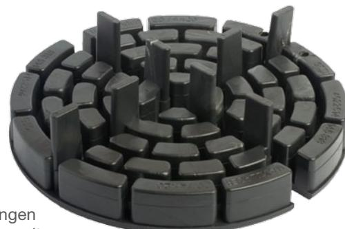
**Anwendung:** Verlegen von Plattenbelägen auf Flachdachabdichtungen oder Betonflächen OHNE Gefälle. Die Verlegung muss mit einer Schutzlage auf der Abdichtung zum Stelzlager aus mind. 200 g/m<sup>2</sup> Rohglasvlies erfolgen.
